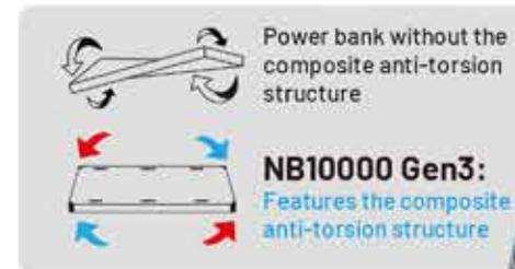
Anti-Torsions-Struktur aus Kohlefaserverbundwerkstoff
